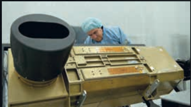
Câmera MUX: 115 quilos e 1,10 metro de comprimento
