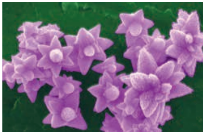
Partículas de óxido de cobre e de zinco, ampliadas milhares de vezes em microscópios eletrônicos
