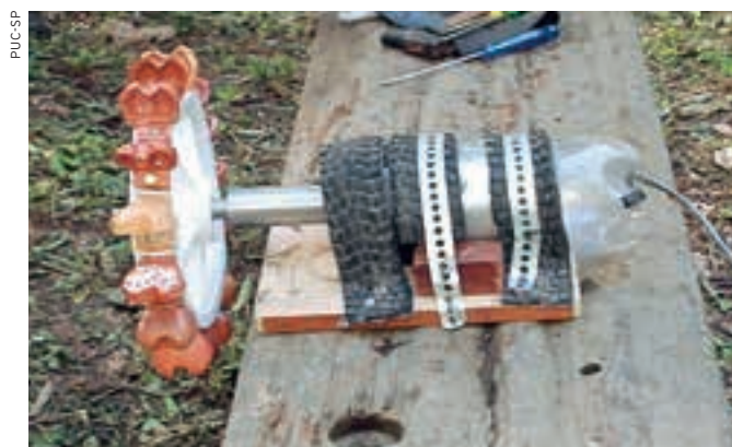
Simples e funcional, turbina é feita de plástico e cerâmica
