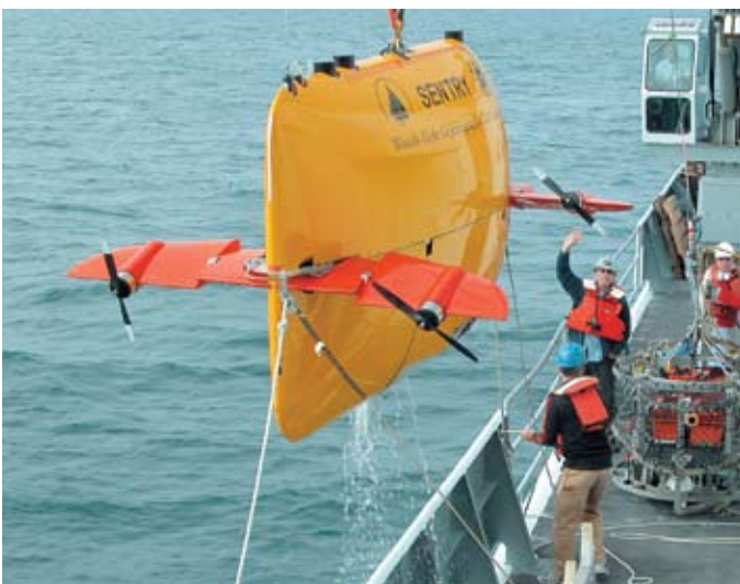
Sentry: autônomo até 5 mil metros de profundidade
