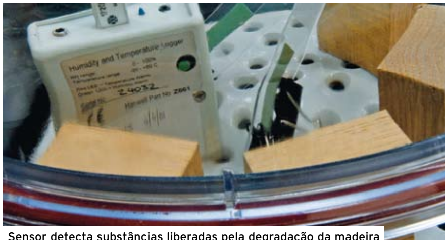
Sensor detecta substâncias liberadas pela degradação da madeira
