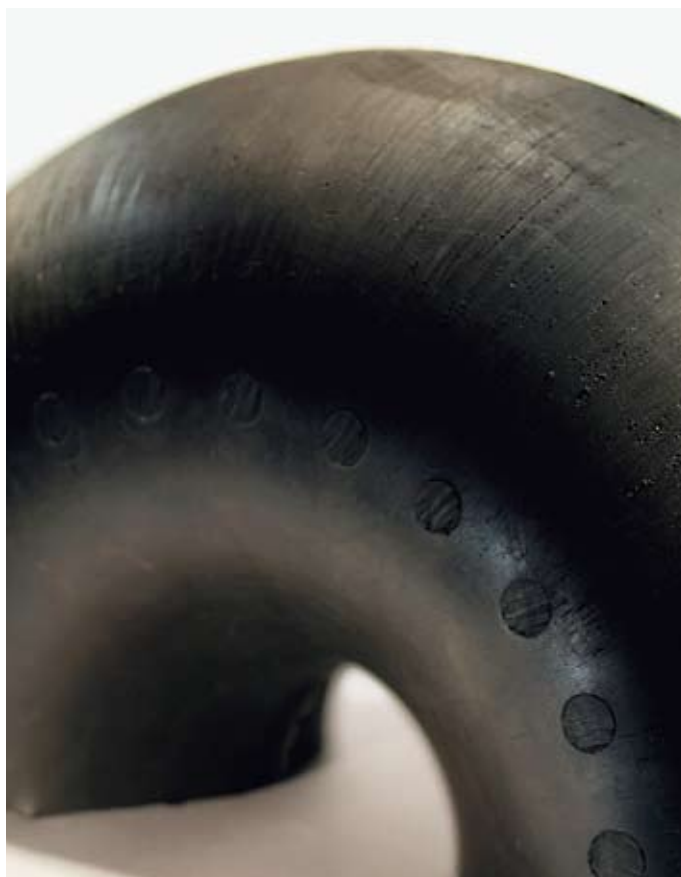
O Imbrik granulado, ao centro, para moldar sola de sapato e, ao lado, anel para molas industriais
