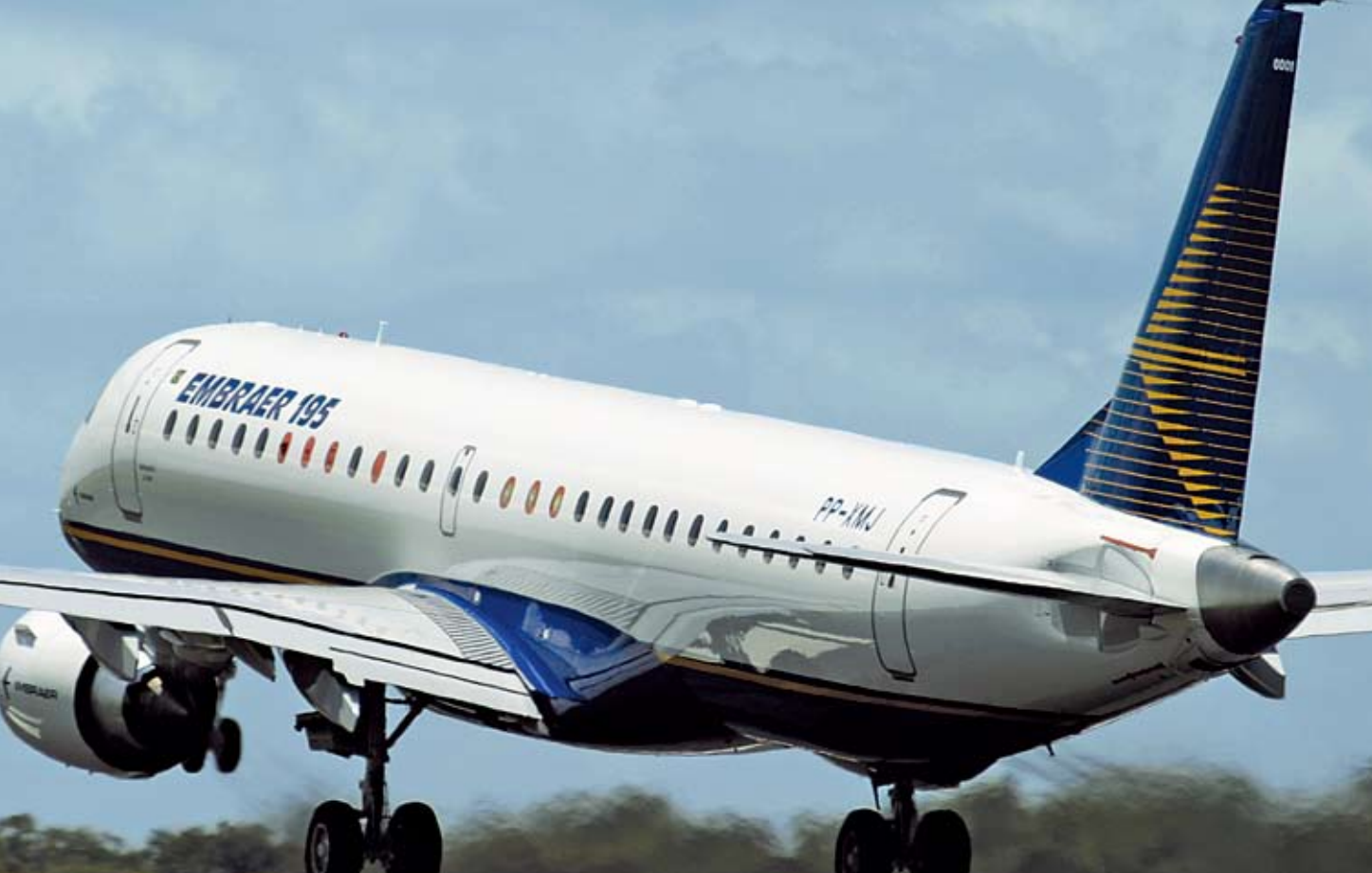
A região das asas e o trem de pouso são os principais responsáveis pelo barulho dos aviões
