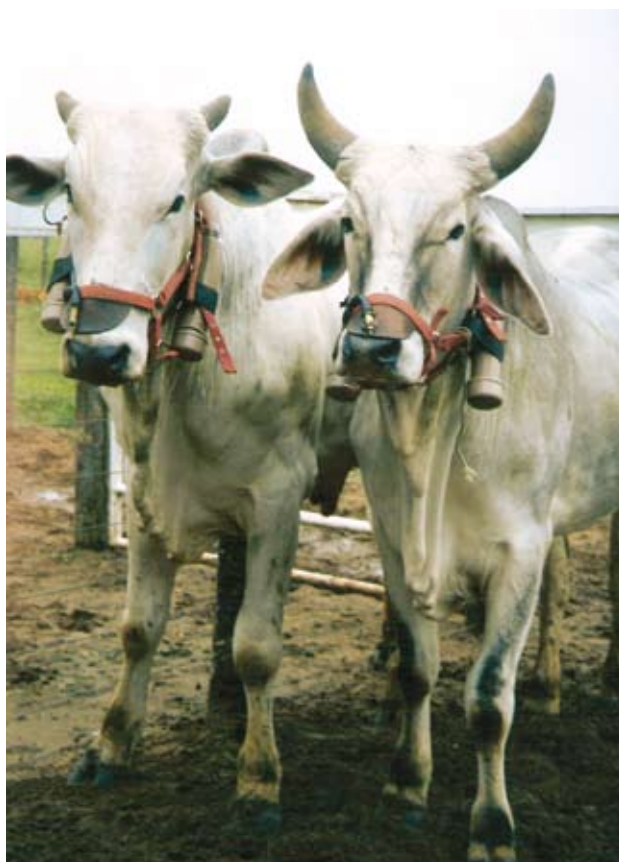
O equipamento de medição de metano fica instalado no focinho e no pescoço durante 24 horas
