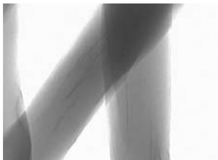
Microscopia eletrônica de nanofibras de nanocompósitos de polímeros com argila montmollironita
