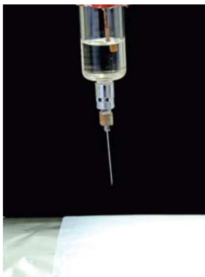
No laboratório, seringa com eletrodo goteja nanofibra para formar a manta
