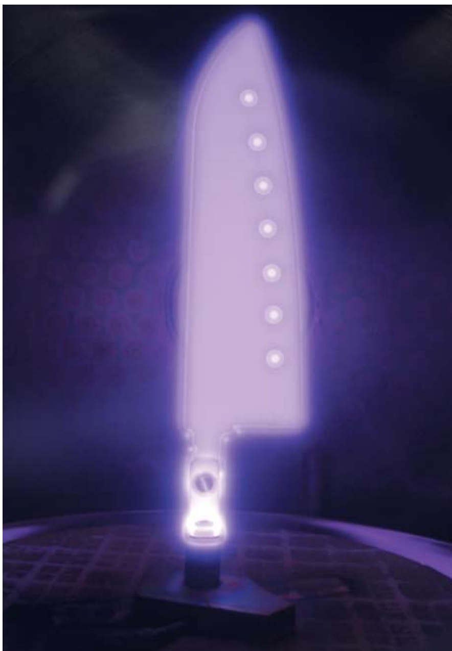
Dentro do reator, faca passa por processo a plasma de deposição de filme de diamante
