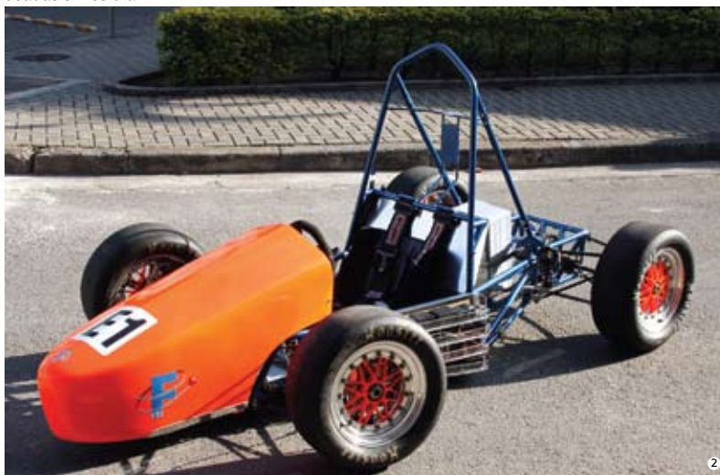
Monoposto da FEI é impulsionado por 1,4 mil baterias usadas em celular
