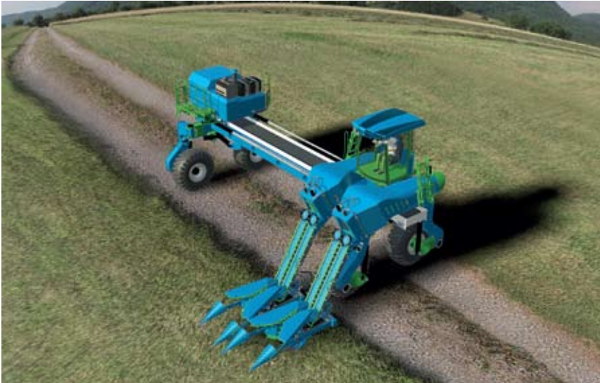
Maquete eletrônica da nova máquina com distância de 9 metros entre os eixos
