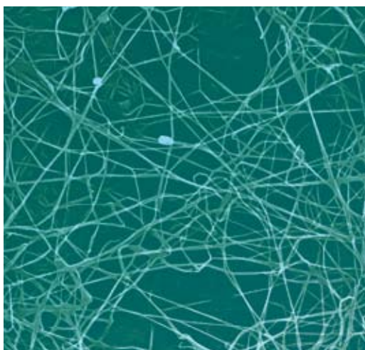
Esponja de fibroína com fios de celulose para regeneração óssea (alto) e membrana de celulose bacteriana
