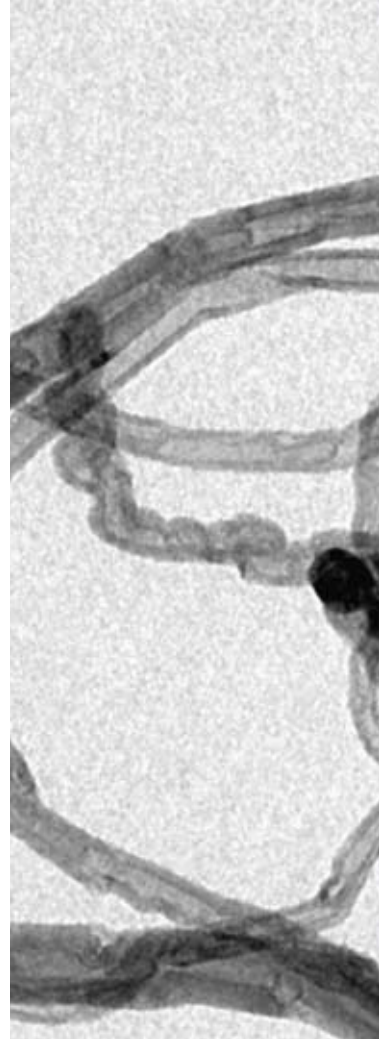
Nanotubos de paredes múltiplas purificados são detectados em microscópio eletrônico de transmissão na Unicamp
