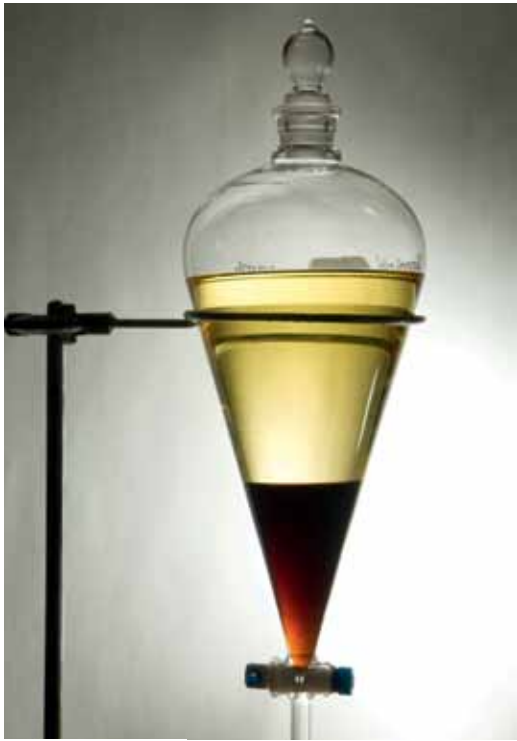
Amostra de biodiesel, em amarelo-claro, e o glicerol, mais denso, na parte inferior
