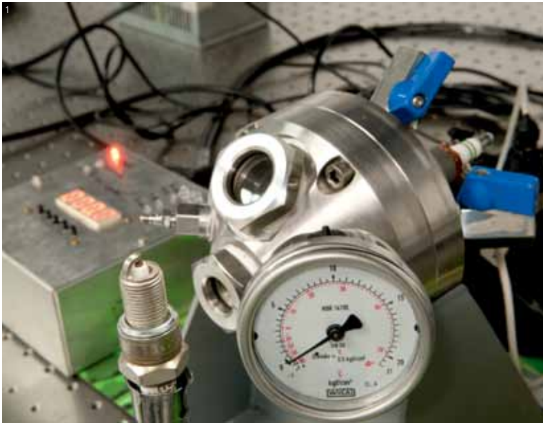
1 No CTBE, equipamento para teste de velas de ignição e estudo da queima de etanol em motores
