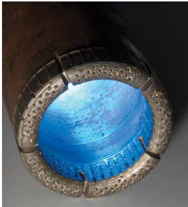
Broca com ponta revestida de diamante sintético para exploração de petróleo
