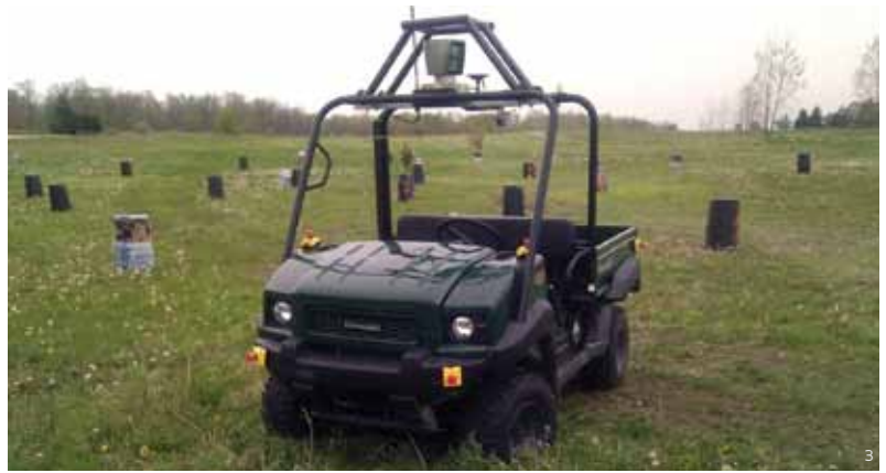
Jipe dotado de câmera e laser evita obstáculos em campo de testes
