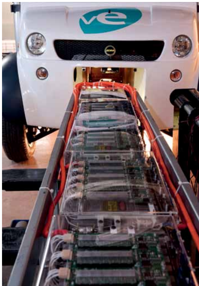
Bateria da Electrocell formada por módulos é instalada em caminhonete
