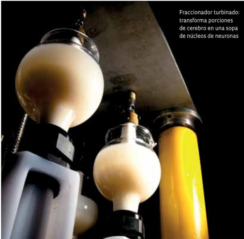
Fracccionador turbinado: transforma porciones de cerebro en una sopa de núcleos de neuronas
