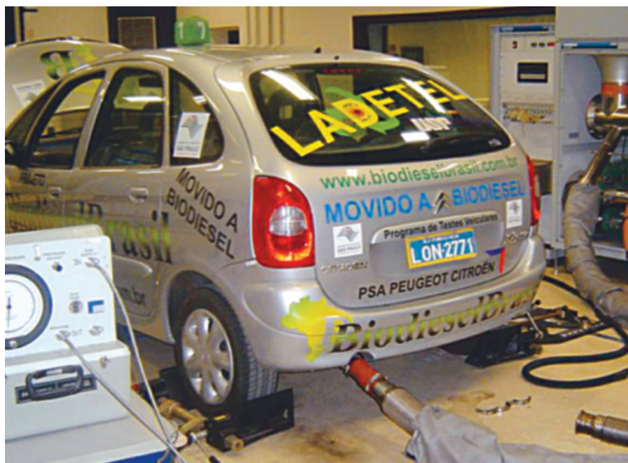
Dans le Lactec à Curitiba, tests sur une voiture fonctionnant avec 30% de biodiesel.
