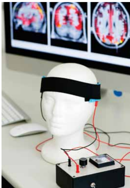
Manequim com bandana e eletrodos do aparelho de estimulação elétrica, usado para esclarecer funções cognitivas (imagens ao fundo)
