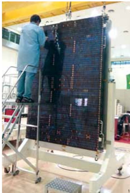
Células solares do satélite sino-brasileiro: 26% de taxa de eficiência energética
