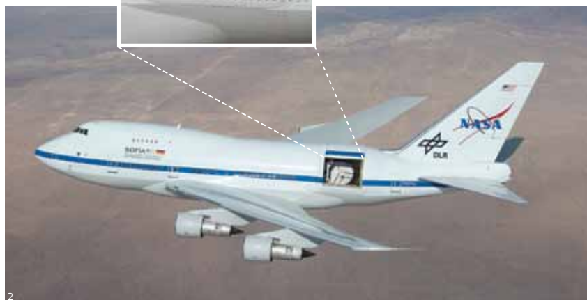
Sofia: observatório instalado num Boeing 747 adaptado
