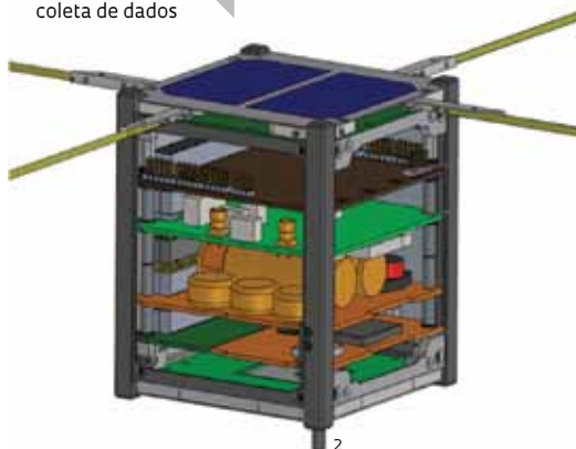
Ilustração do NanosatC-BR1: missão científica, instrumento de ensino e opção barata para coleta de dados
