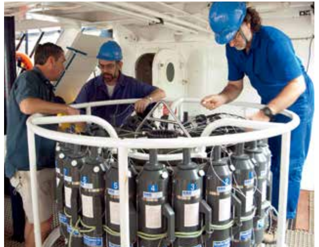
Antes de partir: equipe prepara cilindros de coleta de água
