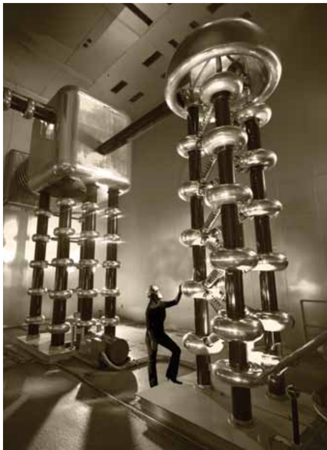
O gerador Cockcroft-Walton, uma das etapas do acelerador de partículas do Fermilab
