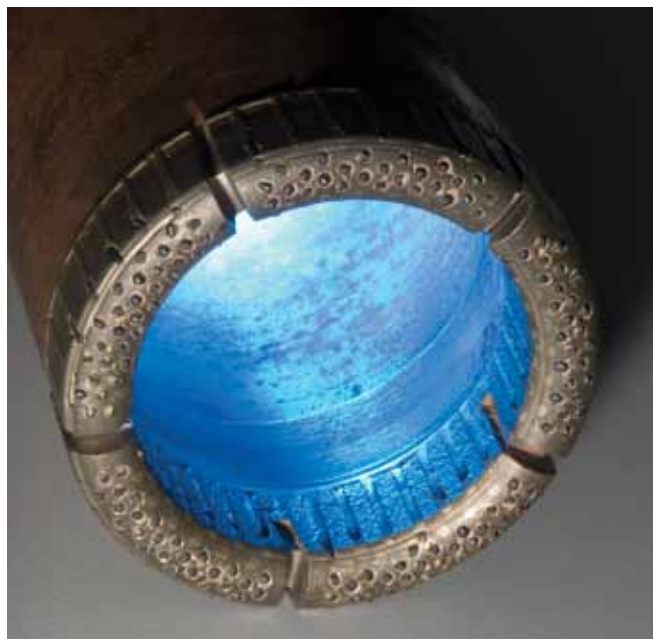
Trépano con punta revestida de diamante sintético para la exploración de petróleo
