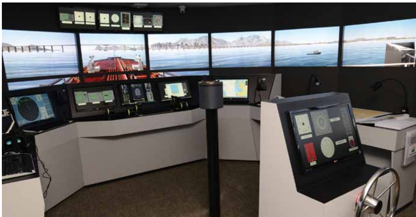
Simulador de manobras para treinar comandantes e práticos de navios desenvolvido pela Technomar, Petrobras e USP
