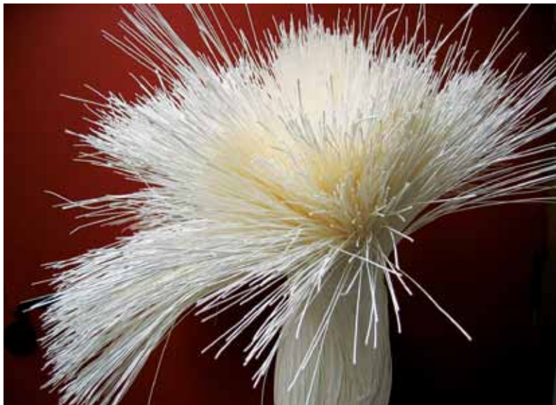
Feixe de fibras da empresa PAM forma membranas para filtrar água (acima). Uso de laser para cortes em metal pela empresa LaserTools (ao lado)
