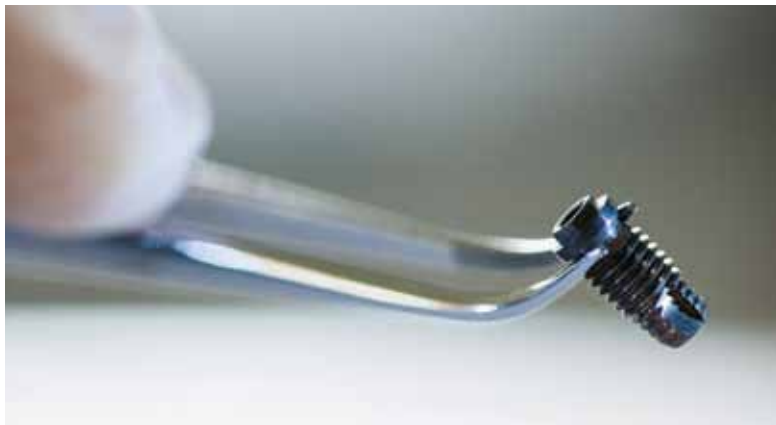
Implante odontológico com cobertura de biovidro, melhor integração com o osso e prevenção de infecções
