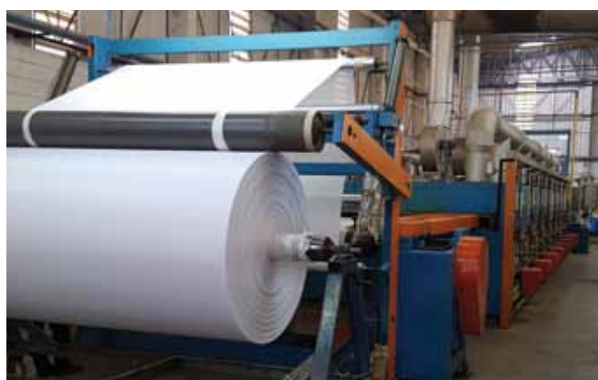
Linha de produção da empresa EPI Saúde, em Campinas: processo de tratamento do tecido com fluorcarbono e nanopartículas de prata
