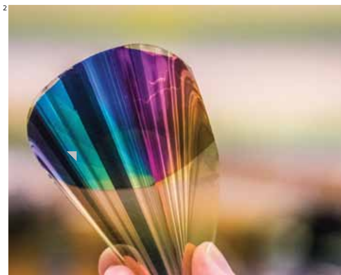
Tela de LED flexível: 1 micrômetro de espessura e baixo consumo de energia
