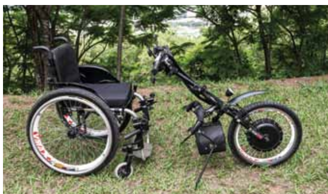
Kit Livre: acessório composto por roda, guidão e motor elétrico recarregável para ser acoplado a uma cadeira de rodas manual
