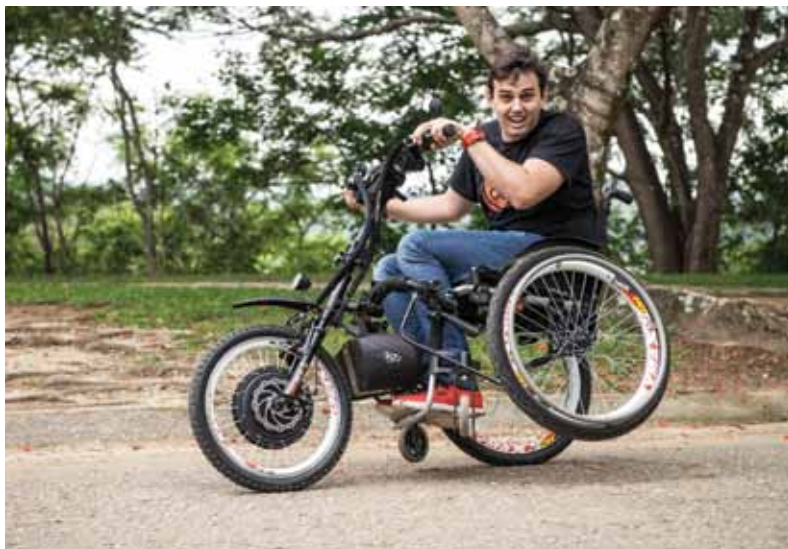
Kit Livre: acessório composto por roda, guidão e motor elétrico recarregável para ser acoplado a uma cadeira de rodas manual
