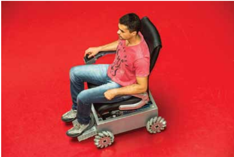
Facilidade de manobras com cadeira que se desloca em todas as direções (acima). Com quatro rodas iguais e onidirecionais, o equipamento tem pequenos roletes que permitem movimentos em qualquer sentido (à esq.)
