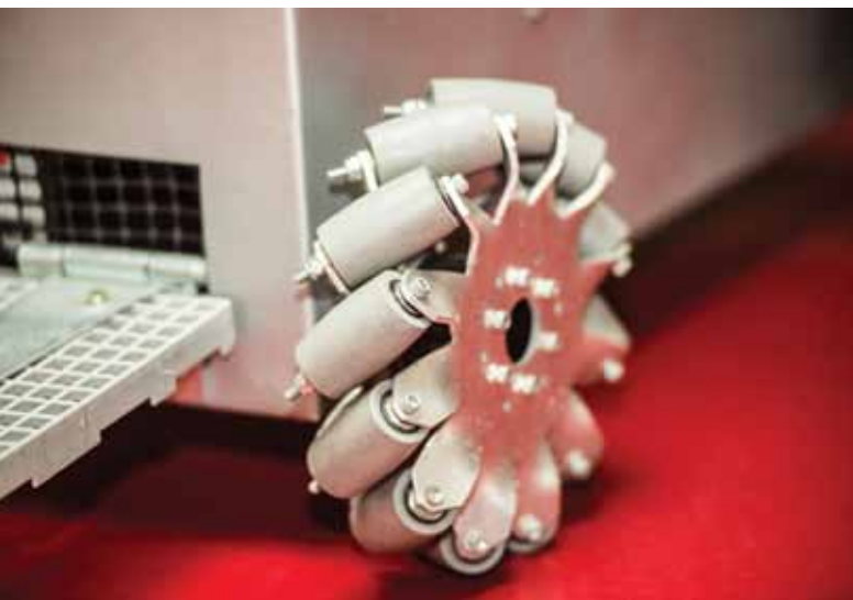
Facilidade de manobras com cadeira que se desloca em todas as direções (acima). Com quatro rodas iguais e onidirecionais, o equipamento tem pequenos roletes que permitem movimentos em qualquer sentido (à esq.)
