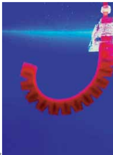
Robô faz movimentos por meio da injeção de água em seu interior
