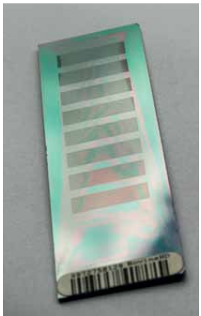
O chip de DNA bovino é uma lâmina com sensores para uso na determinação de parentesco em um grupo de animais e na identificação de defeitos genéticos
