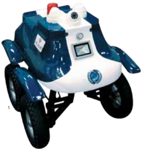
O AutoDrive tem autonomia de oito horas e percorre rotas específicas
