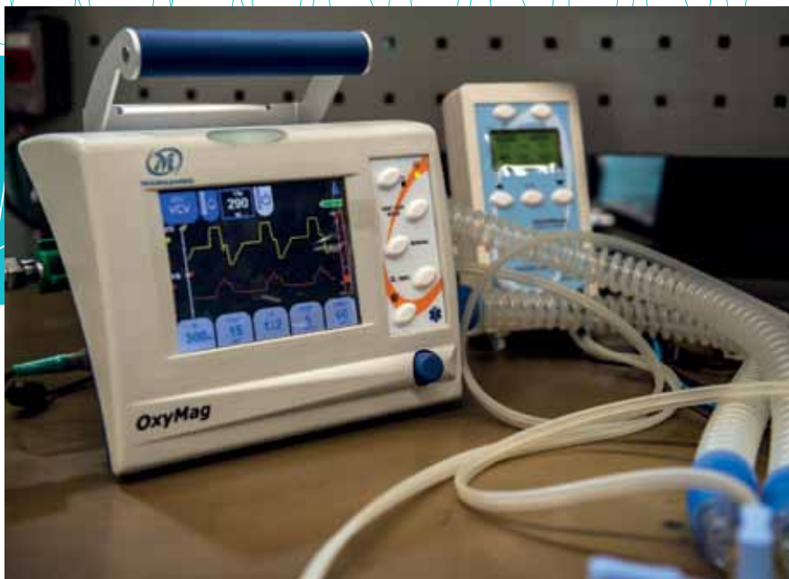
OxyMag é um respirador portátil para uso em ambulâncias com equipamentos de UTI
