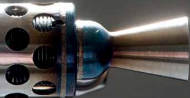
Teste de modelo de qualificação de propulsor que será utilizado no Amazônia-1
