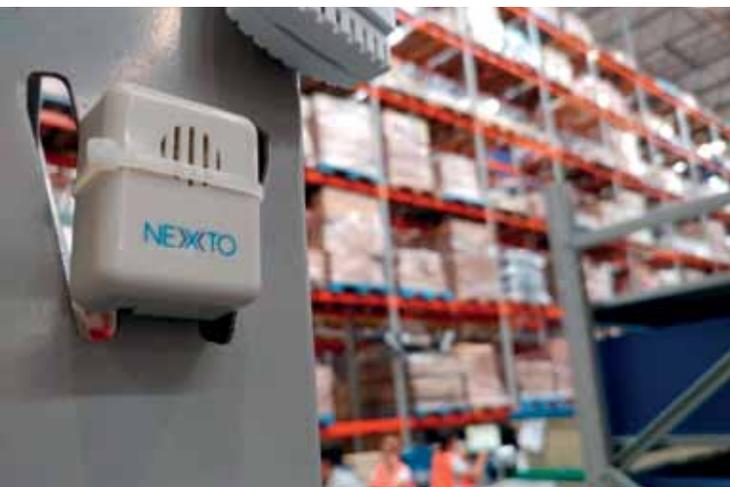
Sensor para monitoramento de temperatura e umidade feito pela Nexxto
