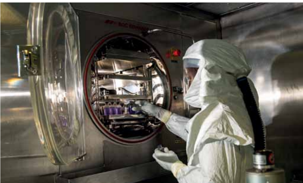
Profissional trabalha no reator de emulsão, usado no encapsulamento de micropartículas
