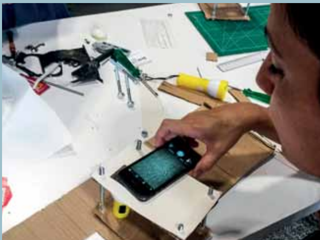
Microscópio acoplado a celular construído a partir de resíduos eletrônicos durante uma das oficinas do Conector Ciência
