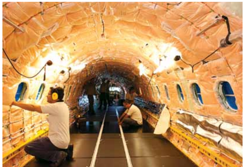
Técnicos trabajando en las diferentes etapas de fabricación, tales como la instalación acústica (debajo)
