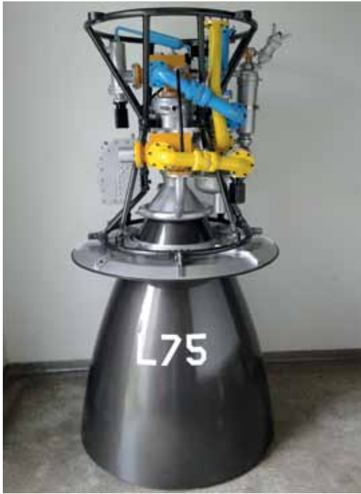
Maqueta del cohete L75 desarrollado en el IAE, que funciona con etanol y oxígeno líquido
