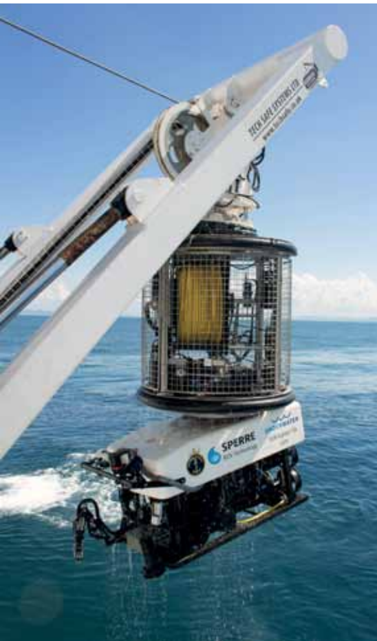
O navio é equipado com um veículo de operação remota (à esq.) e um CTD-Rosette, que mede características físico-químicas da água do mar
