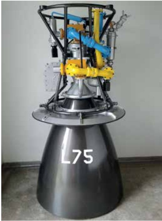
Maquette de la fusée L75 développée à l'IAE, qui fonctionne avec de l'éthanol et de l'oxygène liquide
