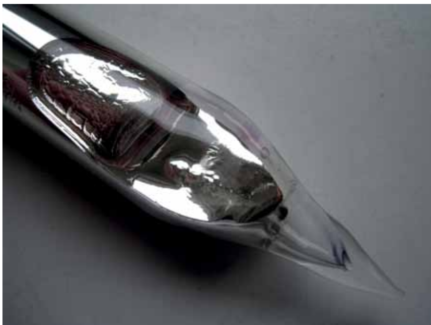
Ampola contendo rubídio, metal utilizado na produção de moléculas ultrafrias
