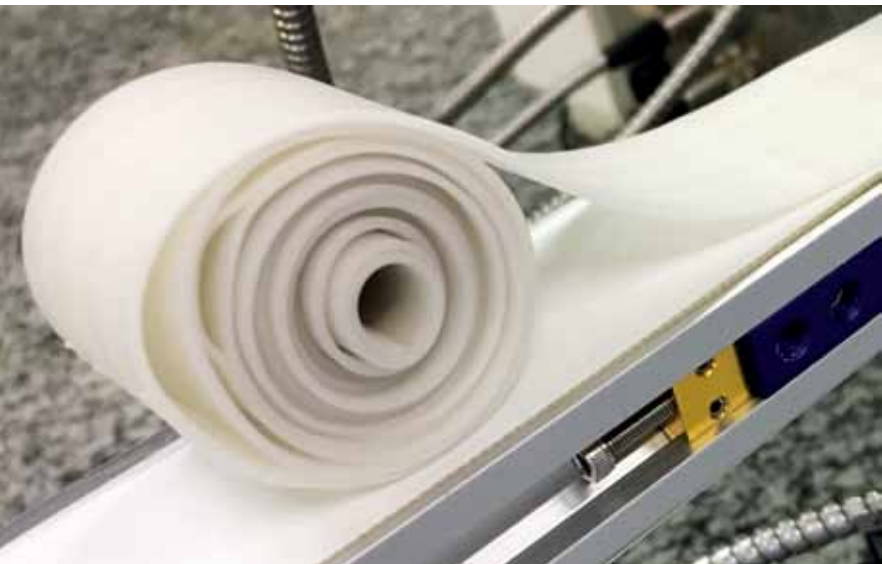
Filme plástico biodegradável feito na USP de Ribeirão Preto a partir de resíduos agroindustriais
