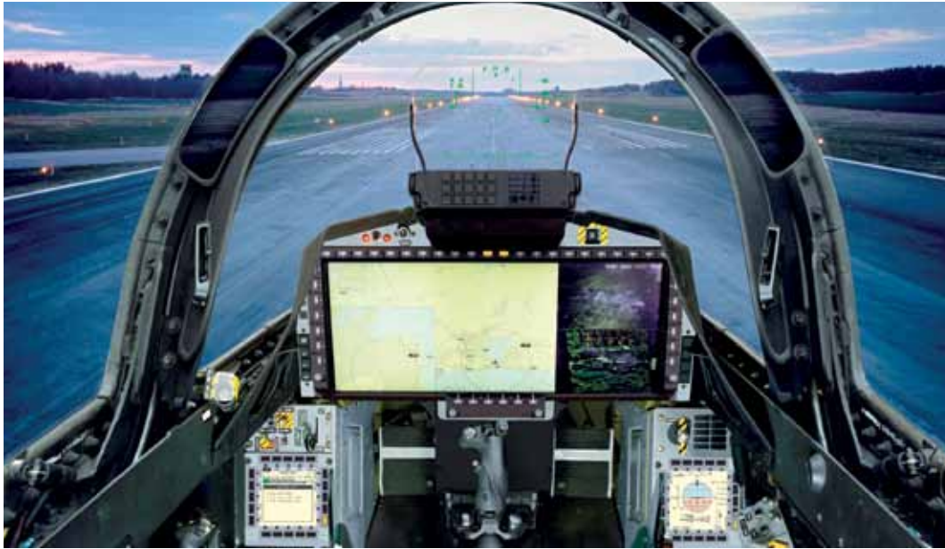
Cabine do Gripen E mostrando os displays WAD (tela amarela no cockpit) e HUD (projeções em verde no visor frontal). Abaixo, piloto usa capacete onde será integrado o aviônico HMD
