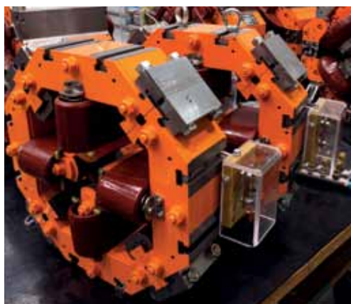
El ingeniero Rafael Seraphim realiza una prueba del sistema de vacío de las cámaras que conducirán los electrones. Al lado, magnetos cuadrupolares, uno de los componentes del anillo de almacenamiento
