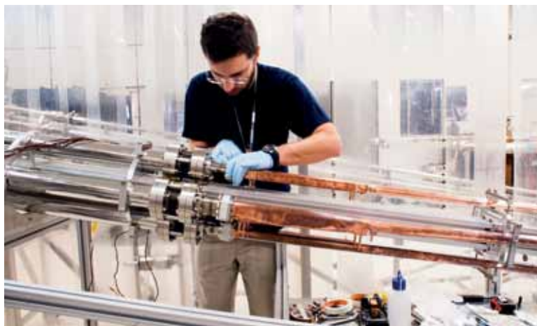
El ingeniero Rafael Seraphim realiza una prueba del sistema de vacío de las cámaras que conducirán los electrones. Al lado, magnetos cuadrupolares, uno de los componentes del anillo de almacenamiento
