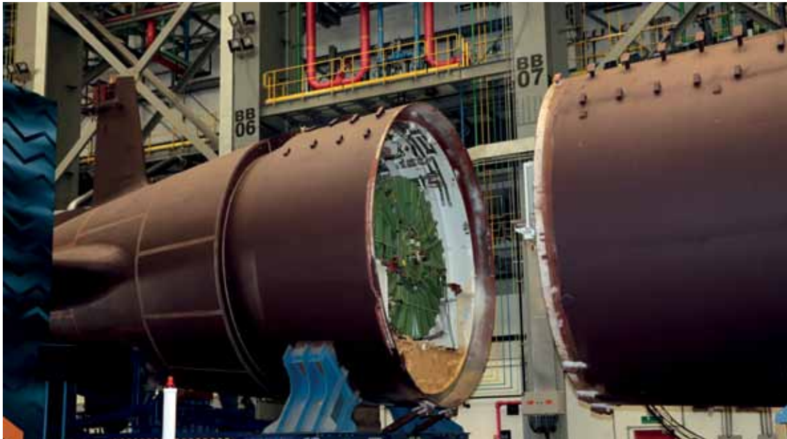
El montaje de las dos secciones del Riachuelo, en la base naval de Itaguaí (Río de Janeiro)
