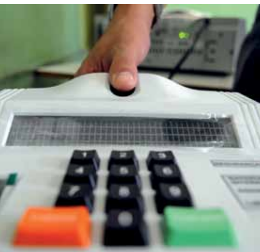
La urna electrónica con identificación digital utilizada en algunas secciones electorales de Brasil
